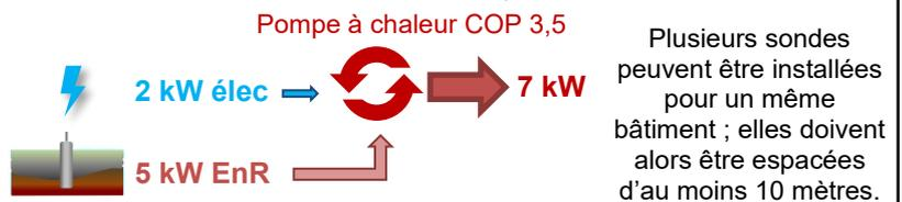
Dans le cadre d'un projet sur nappe, tout va dépendre de la disponibilité de la ressource (débit de pompage en m<sup>3</sup>/h possible) et de la température de l'eau. La performance est généralement légèrement supérieure à très supérieure par rapport aux sondes verticales.
